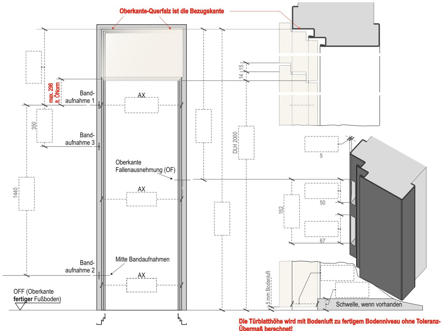
**Die Türblatthöhe wird mit Bodenluft zu fertigem Bodenniveau ohne Toleranz-Übermaß berechnet!**
