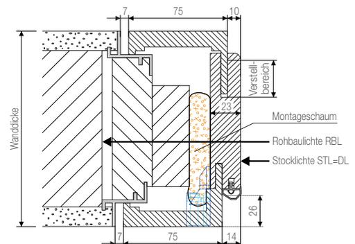
DANA Plano-Blindstock: Blindstock für DANA Plano-Zargen, für Standardwanddickennennmaße, Profilbreite (PB) = Wanddicke einschließlich Putz. Profilform asymmetrisch. Die Montage erfolgt verschraubt/geschäumt oder mitgemauert.
