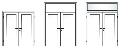
2-flügelig, mit/ohne Verglasung, mit/ohne Oberblende, mit/ohne Oberlichtverglasung
